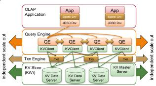
Figure 1. DQE distributed architecture.
